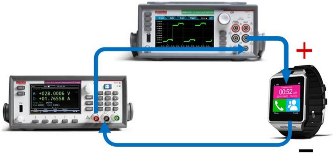
KSC-4000A 低功耗直流特性分析软件具备短时间内高速电流采样记录功能，以及长时间低速电流采样记录功能；软件还提供 CCDF 统计功能，计算一段时间内不同幅度电流值的分布情况，有助于整体了解设备耗电情况。测量数据可以导出成 CSV 或二进制文件，进行后续的数据处理和分析。
